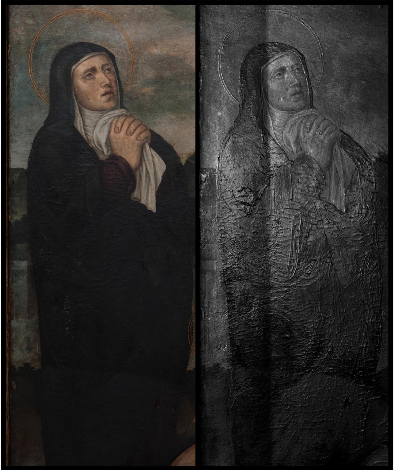
Fig. 15 Registro del deterioro en una pintura al óleo sobre madera visto sin filtro (izquierda) y con filtro especular (derecha). El filtro especular permite ver las pinceladas originales así como los patrones de craquelado, la deformación del soporte de madera, los faltantes, rasguños, etcétera sin la interferencia visual del color.
