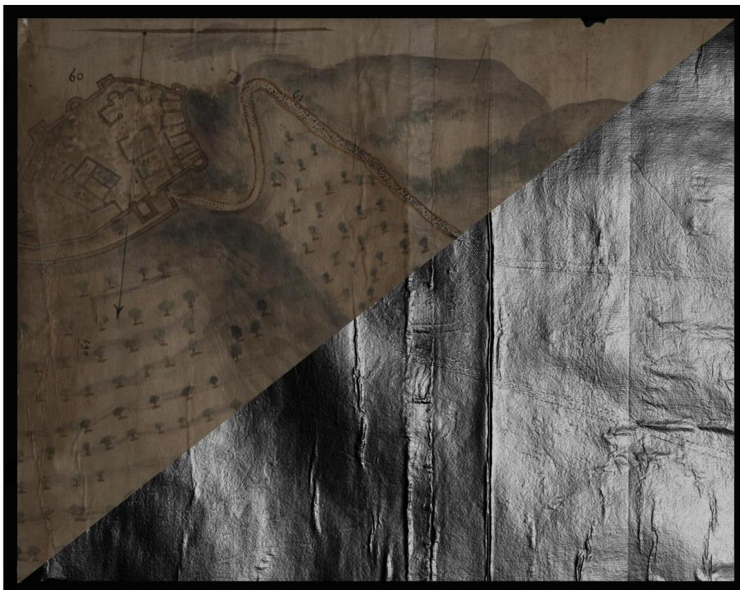
**Fig. 8** Imagen compuesta mostrando una pintura al agua en RTI sin filtro (izquierda) y con filtro especular (derecha). En el área central derecha se aprecian las marcas horizontales que definen el camino y que fueron hechas con una punta o instrumento duro. El resto del dibujo “desaparece” al reducirse la información de color porque la pintura al agua no ha dejado huella en la textura del papel. *Imagen usada con permiso del IVC+R*
