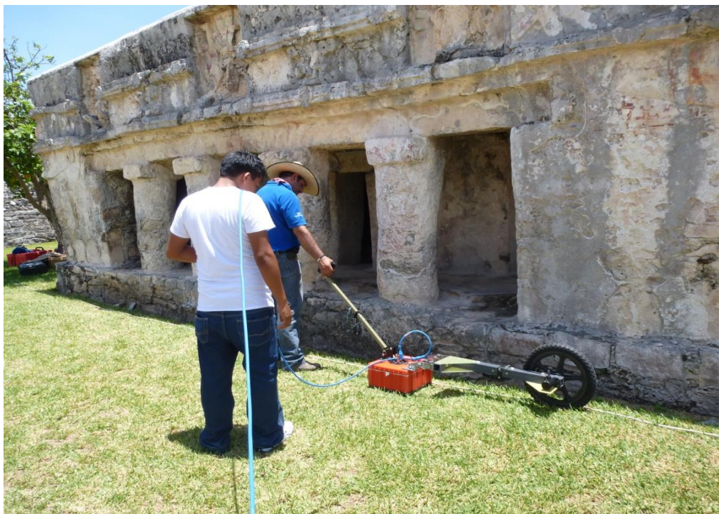
Figura nº19 - Frente al Templo o Edificio XVI, sondeo de sur a norte con la antena de 400MHz.
