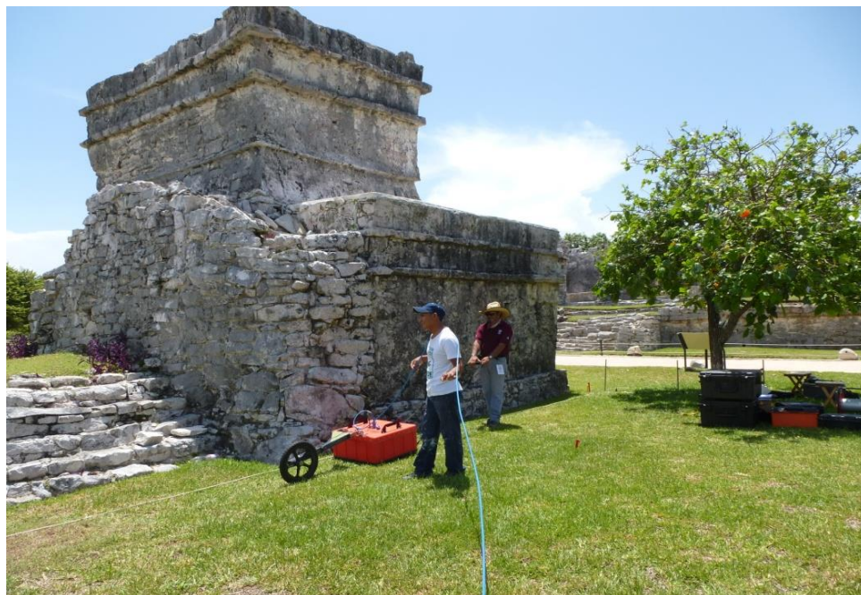
Figura nº 17 - Lado norte (NE) del Edificio XVI. Sondeos con la antena de 200 MHz.
